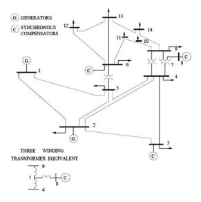
Fig. 5. IEEE 14-bus test system.
