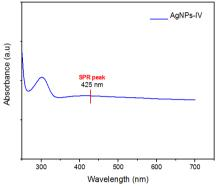
Fig. 3. UV-Vis Spectrum of AgNPs-IV.
