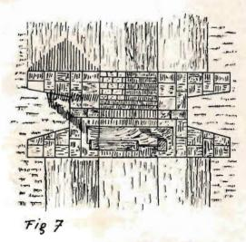
Planta de una compuerta.
