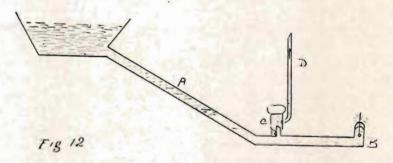
Ilustración del principio del ariete hidráulico.
