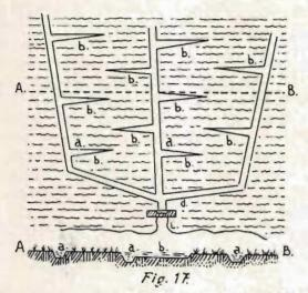
Disposición para humedecer un terreno drenado al aire libre. Riego por filtración.
