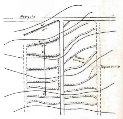
(fig. 19). Riego por curvas de nivel.
