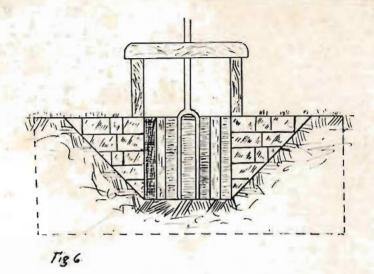
Alzado de una compuerta.
