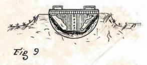
La compuerta de la fig. 8 colocada en la entrada de la atarjea.
