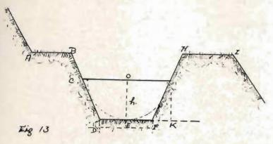
Sección de un canal de riego o de drenaje.
