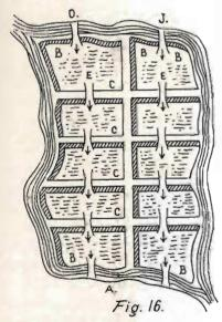
Disposición de un arrozal dividido en tablas o cuadriláteros de riego.
