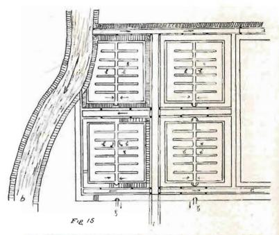
Riego por submersión. Planta de una instalación de cuatro compartimientos.
