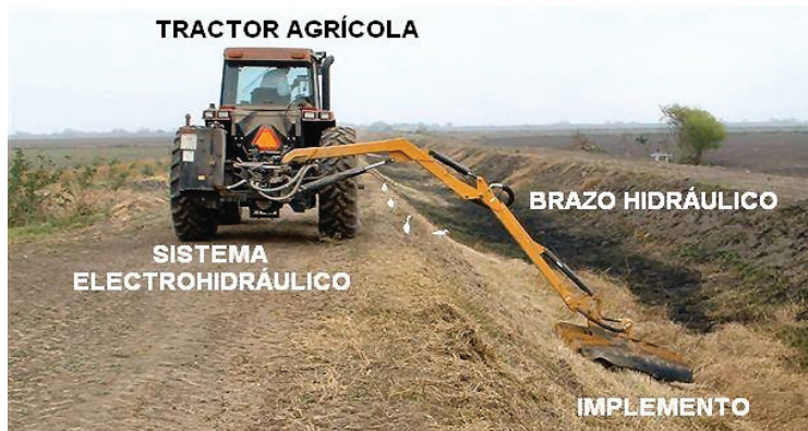
Figura 1. Partes de un equipo ligero empleado para el control de maleza en los Distritos de Riego de México.
