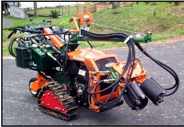
Figura 2. Vibrador multidireccional de tallos de café “VITAC-1” desarrollado en CENICAFE (2001).
