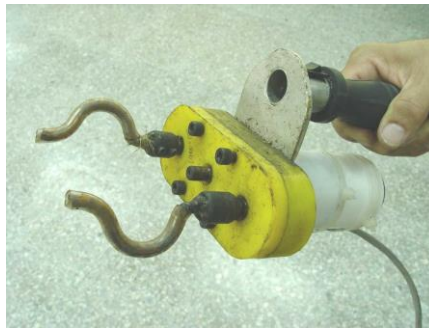
Figura 1. Actuador del equipo IMFRA 2DC construido para la cosecha manual de café.
