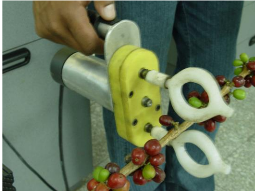
Figura 2. Actuador IMFRA-3DC, diseñado para la cosecha manual de café. Se observan los cambios introducidos en los impactadores (en Teflón y forma elíptica), la rotación (90°) del mango de sujeción. Adicionalmente se construyó en aluminio la cubierta que protege al motor.
