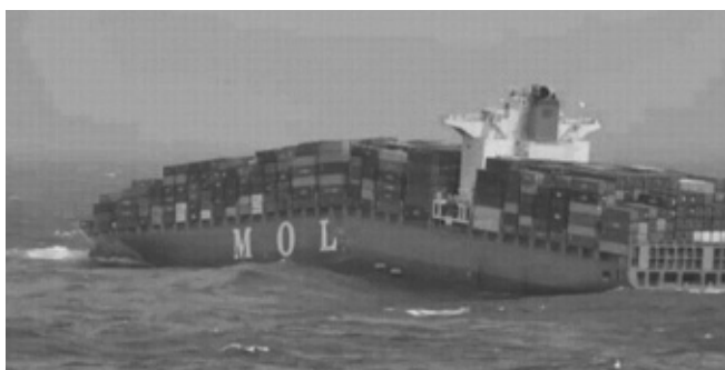
Rys. 1. Kontenerowiec złamany w wyniku silnego sztormu Fig. 1. Container ship broken as a result of a strong storm
