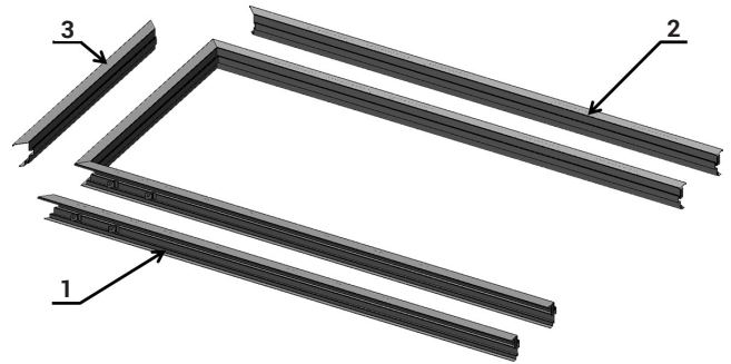
Rys. 5. Budowa ościeżnicy Fig. 5. Construction of the door frame
