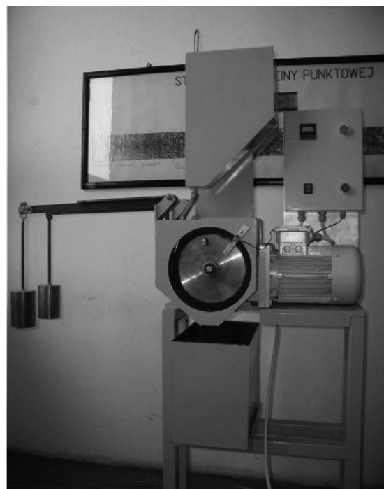
Rys. 1. Stanowisko do badań odporności na zużycie ścierne typu metal-minerał przeprowadzonych zgodnie z normą ASTM G 65-00, Procedura A Fig. 1. Metal-mineral wear resistance test stand – according to ASTM G65-00, Procedure A standard
