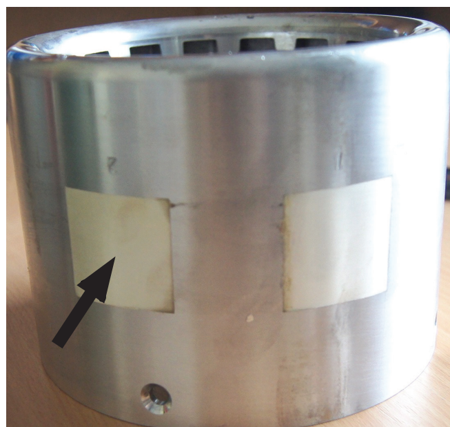
Rys. 7. Tuleja ze stopu aluminium z 2 powłokami srebra o grubości 10 μm Fig. 7. Aluminum alloy sleeve with 2 silver coatings, thickness 10 μm
