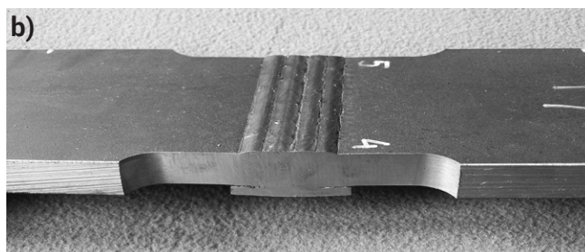
Rys. 2. Kształt i wymiary próbek do badań zmęczeniowych: a) schemat próbek, b) widok próbki
