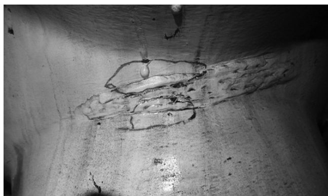
Rys. 4. Badania magnetyczno-proszkowe. Pęknięcie w miejscu wykonania wcześniejszej naprawy [1]
