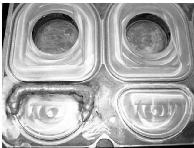
Rys. 5. Przykład formy do zgrzewania elementów pojemników spożywczych z tworzyw sztucznych
