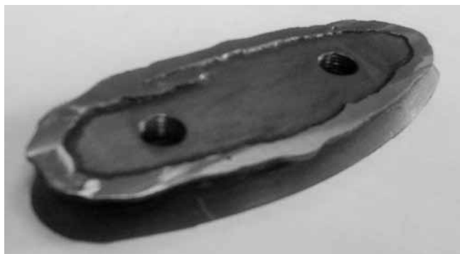
Rys. 6. Wkładka z brązu berylowego napawana Stellitem 1 stosowana do aluminiowych form do rozdmuchiwania opakowań polimerowych
