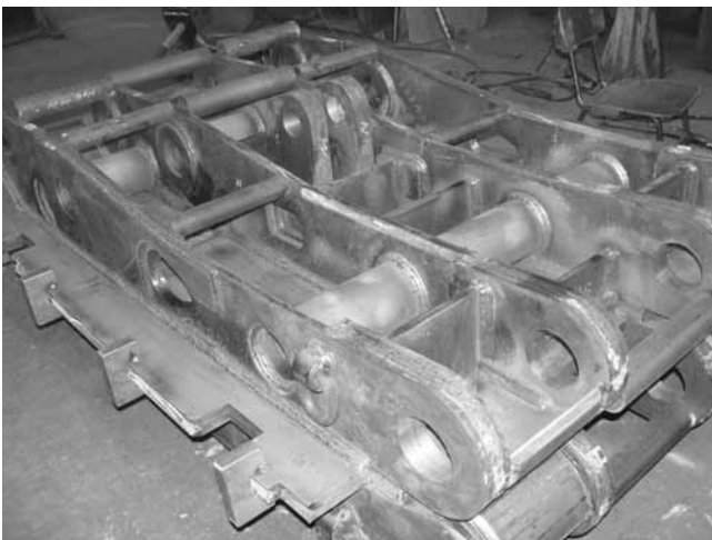
Rys. 8. Osłony po spawaniu w I etapie szczipione „plecami” do siebie i usztywnione rozpórkami w celu zapobieżenia odkształceniom spawalniczym
