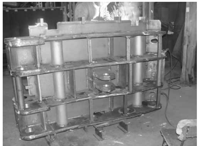
Rys. 11. I etap spawania – konstrukcje szczipione i usztywnione
