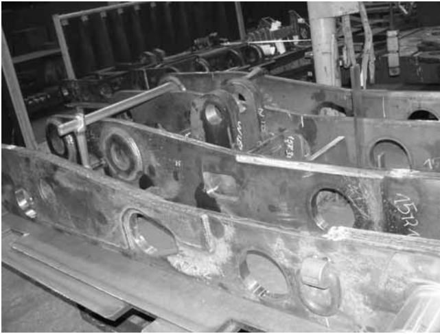
Rys. 6. I etap składania – stosowanie ścisków do ustawiania i szczipiania
