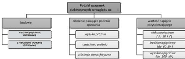
Rys. 2. Podział spawarek elektronowych. Opracowanie własne na podstawie [2] Fig. 2. Electron beam welder classification. Own study based on [2]
