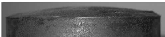
Rys. 8. Przelom zmęczeniowy czopa osi kolejowej zainicjowany pod kątem ok. 20°
