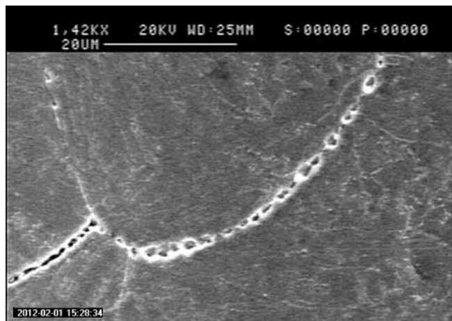
Rys. 7. Pęknięcia relaksacyjne w spoinie Fig. 7. Reheat cracks in weld metal
