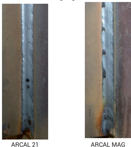
Rys. 8. Porównanie lica w złączach kątowych wykonanych w pozycji PB dla mieszanek 8% CO 2 i 18% CO 2 w argonie
