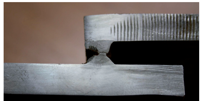
ARCAL MAG: Ocena negatywna – kruche połączenie ARCAL MAG: negative result – brittle connection
