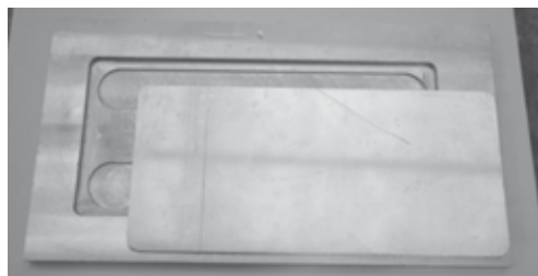
Rys. 2. Modelowa chłodnica. Pokrywa – stop EN AW-2017A. Odlewany korpus – stop EN AC-43200 Fig. 2. Model radiator. Cover plate – EN AW-2017A alloy. Casting frame – EN AC-43200 alloy
