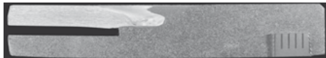
Rys. 20. Makrostruktura zgrzeiny FSW w miejscu A2 z rys. 3 Fig. 20. Macrostructure of FSW weld in the point A2 from Fig. 3
