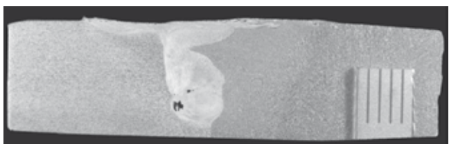
Rys. 11. Makrostruktura zgrzeiny FSW. Materiał EN AW-2017A od strony natarcia. Parametry zgrzewania: nr 15 z tabl. V Fig. 11. Macrostructure of FSW weld. EN AW-2017A by the advancing side. Welding parameters: no 15 from table V
