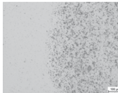
Rys. 19. Mikrostruktura fragmentu zgrzeiny FSW. Materiał EN AC-43200 od strony natarcia. Parametry zgrzewania: nr 3 z tabl. V. Przejście pomiędzy materiałem zgrzeiny a materiałem rodzimym od strony spływu. Traw. Keller
