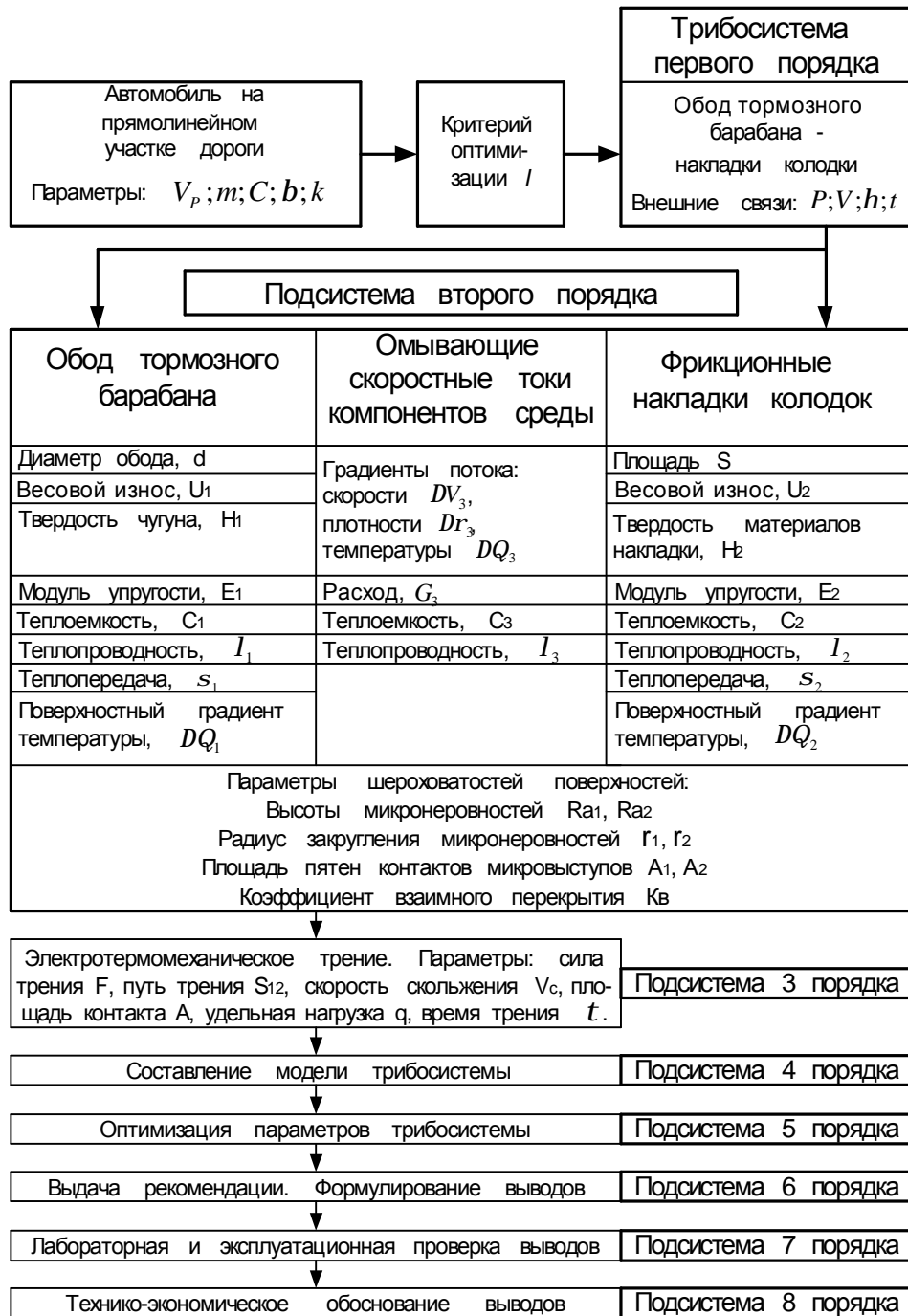
Рис. 2 – Структурная схема электротермомеханического трения и изнашивания фрикционного узла "обод тормозного барабана - накладки колодки"
