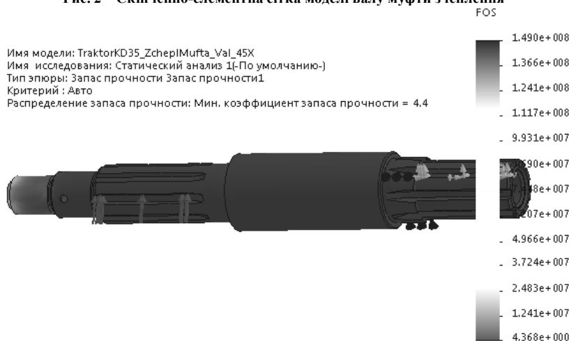
Рис. 2 – Розподіл запасу міцності для сталі 40X
