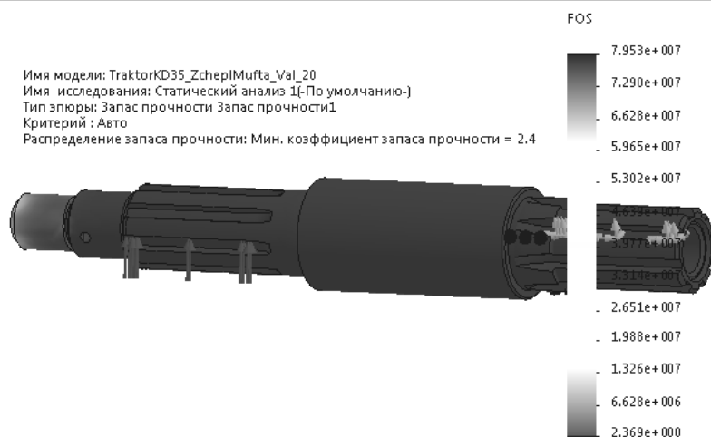
Рис. 4 – Розподіл запасу міцності для сталі 20
