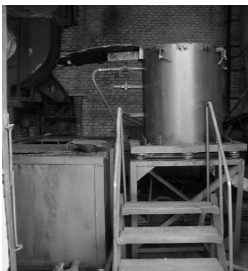
Рис. 1 – Установка для приготовления эмульсии
