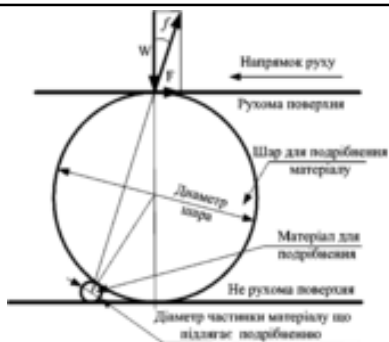
Рис. 1 – Схема здрібнення СМ за принципом роботи клина
