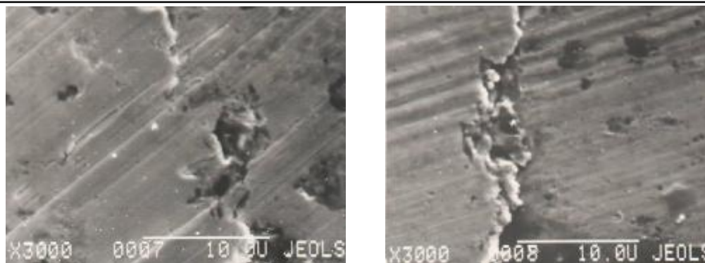
Рис. 7 – Поверхности трения покрытия FeAl 2 -Ti-Si, иллюстрирующие кинетику процесса разрушения, после испытаний при 650 °С
