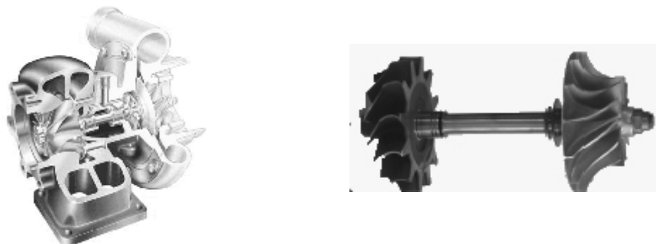
Рис. 1 - Конструкція роторного вузла турбокомпресора ТКР-7Н1
