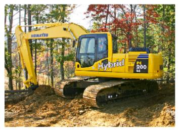
FIGURE 14: Excavator scoops up earth and turns the tower to the place where the earth is deposited. The drive of rotation is electrical, when rotation is braking the energy is stored in a super-capacitor and subsequently is used for rotation in the opposite direction. OBRÁZEK 14: Rýpadlo nabere zeminu a otáčí věž na místo, kde zeminu vysype. Pohon otáčení je elektrický, při brzdění pohybu je energie uložena v superkondenzátoru a následně je použíta pro otáčení v opačném směru.
