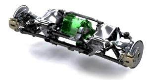
FIGURE 6: Hybrid4 models Peugeot / Citroen uses an electric motor connected to the rear axle via a gear and a clutch. Vehicles with this drive may drive in pure electric mode, hybrid mode or as a 4x4 OBRÁZEK 6: Modely Peugeot / Citroen HYbrid4 používají elektrický motor připojený k zadní nápravě přes převod a spojku. Vozidla s tímto pohonem mohou jet v čistě elektrickém režimu, hybridním režimu nebo jako 4x4
