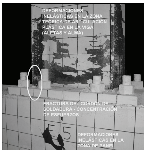
Figura 18. Deformaciones inelásticas en el espécimen E-5. Secuencia de plastificación
