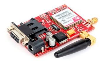
Fig. 5. SIM900A GSM Module [2]
