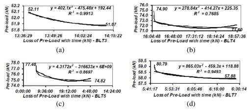
Fig. 4 Loss of Pre-load with Time. (a) Bolt-3, (b) Bolt-4, (c) Bolt-5, (d) Bolt-7.
