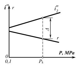
Fig. 3. Diagram to determine the parameter  $\Delta$
