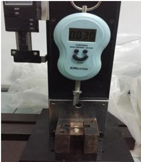
Gambar 6. Pengukuran kekuatan geser menggunakan Universal Testing Machine
