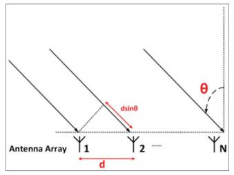
AQ1 Figure 3: Angle of arrival positioning<sup>[9]</sup>
