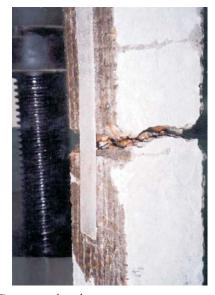
Fig. 2: FRP-concrete bond test
