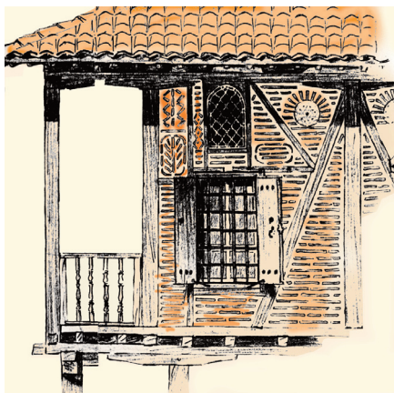
FIGURE 33. Hımsî infill technique –Bursa (Bitli Ev, 17 th Century) (Eldem, 1984, Interpretation: Dışkaya, H.).
