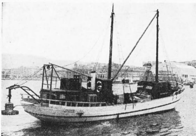
Fig. 9- La batisfera fissata fuori bordo per lo spostamento da una stazione all'altra.
