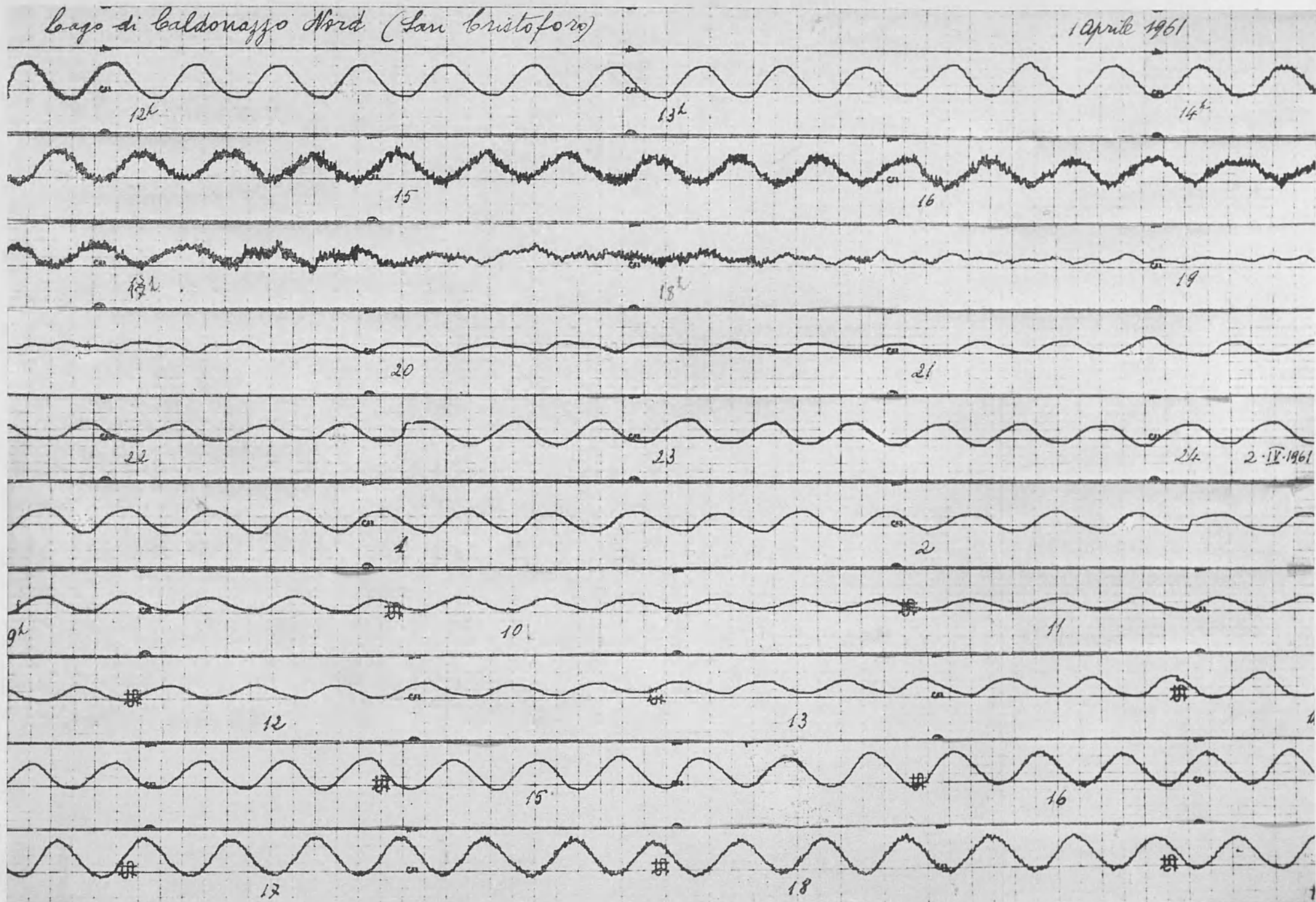
Fig. 19 - Attività normale di uninodali nella parte Nord del lago di Caldonazzo: in concomitanza al soffiare del vento, le uninodali sono andate scemando d'ampiezza, per rompersi infine in lievi binodali. Verso le 20 h del 1° Aprile si ha la ripresa delle uninodali.
