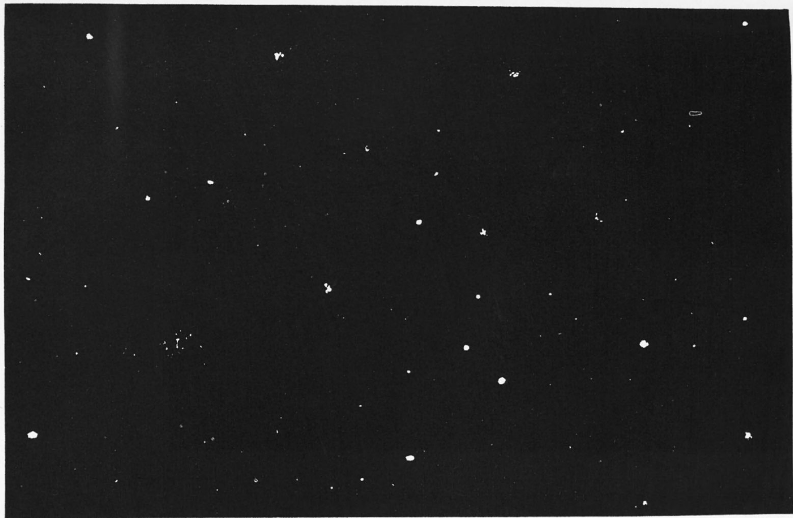
Fig. 1 - Cristalli di ghiaccio ottenuti in camera fredda con nuclei di ioduro d'argento. Temperatura -10^{\circ}\text{C} .
