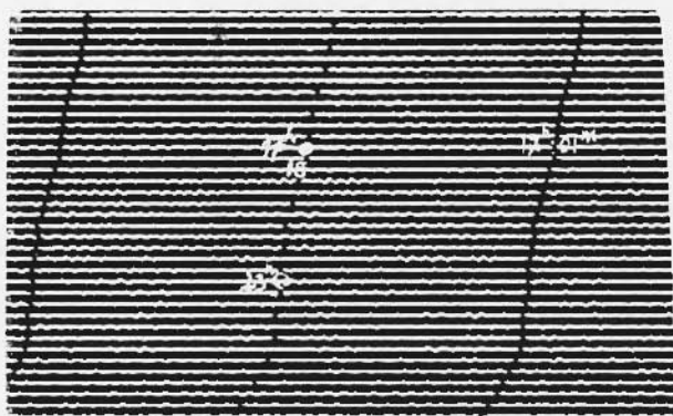
Fig. 25 - Anche a Vienna -- a ca 355 km di distanza -- giungono i microsismi, associati al transito del ciclone del 15.VII.1970 sul golfo di Trieste. Come a Trieste, e nelle altre stazioni d'osservazione, l'agitazione presenta dei massimi verso le 18 h 30 m (ora di Greenwich), conserva il medio periodo della zona-origine (2 s ,7 ca), ma è fortemente ridotta in ampiezza.
