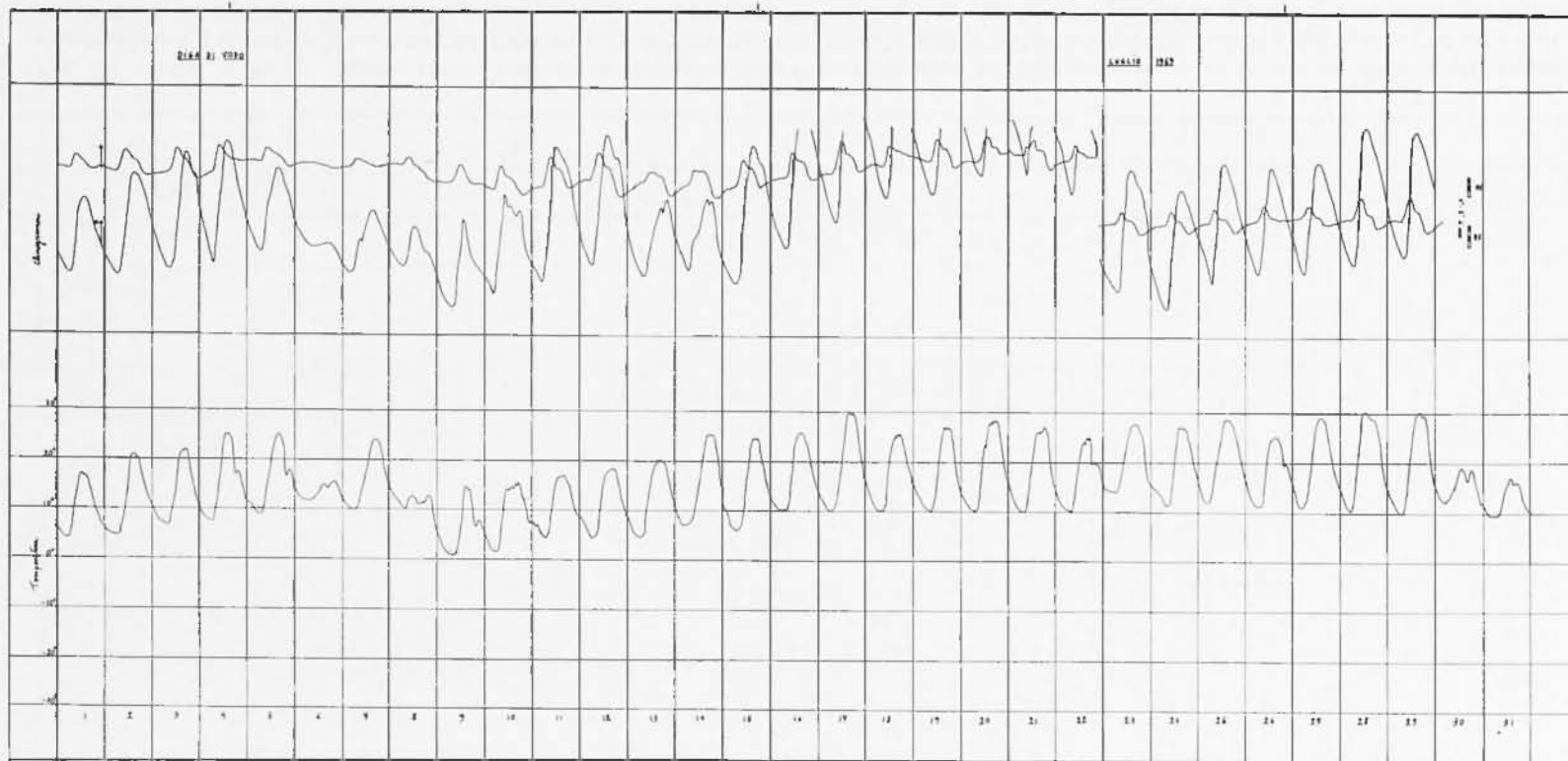
Fig. 9 - Diga di Vodo - Luglio 1969 - Le variazioni d'inclinazione a lungo periodo nella componente sinistra-destra sono generalmente a destra per riscaldamento. E anomala la situazione nei giorni 9-10. Per il resto osservazioni analoghe a quelle fatte per Giugno.
