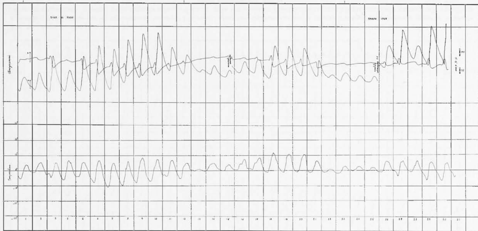
Fig. 5 - Diga di Vodo - Marzo 1969 - L'iniziale rotazione a destra nelle onde diurne della componente sinistra-destra è, in questo mese, ben netta. Notevole il parallelismo fra l'andamento termico e le variazioni della verticale apparente della componente monte-valle. Le variazioni a lungo periodo della componente sinistra-destra sono incerte per quanto concerne il verso.
