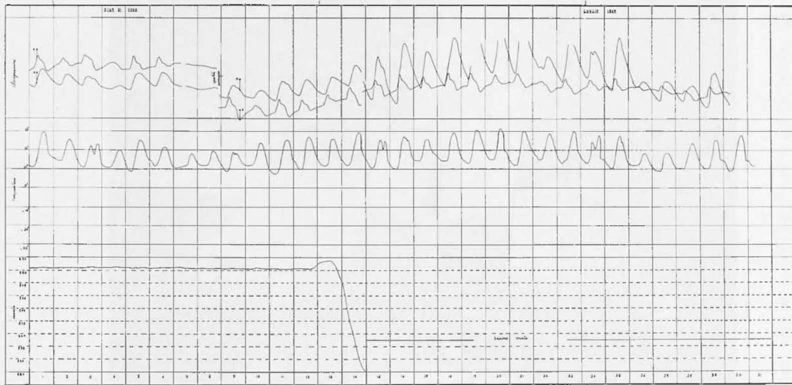
Fig. 2 - Diga di Vodo - Luglio 1967 - Si hanno esempi evidenti di onde diurne dopo lo svuotamento del bacino. L'oscillazione diurna in direzione sinistra-destra non mostra variazioni appariscenti. L'onda diurna della componente monte-valle risulta più ampia a bacino vuoto, pur essendo le escursioni termiche dello stesso ordine di quelle a bacino pieno.
