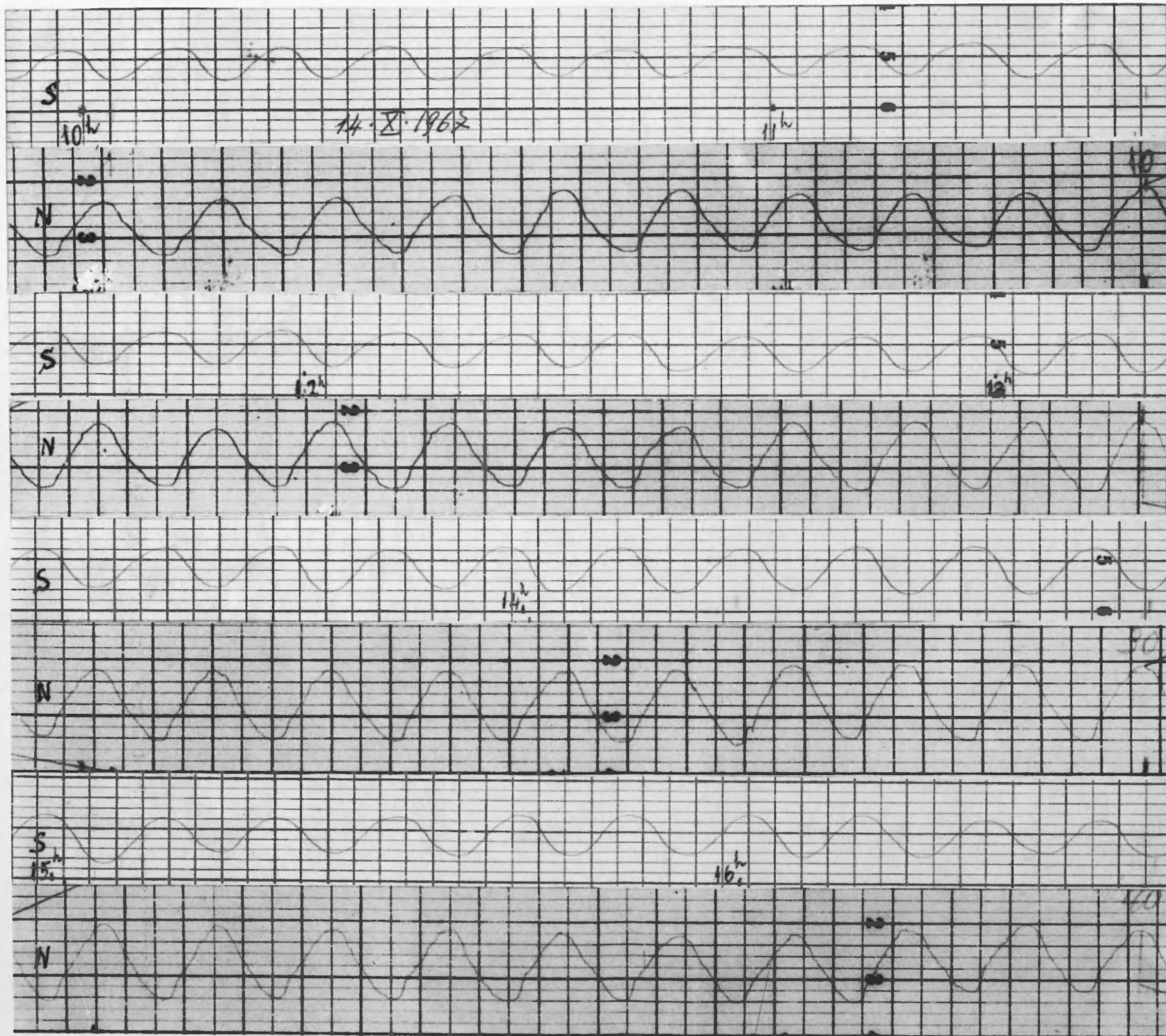
Fig. 6 - Contemporanea registrazione di uniodali a Sud (Lido di Caldonazzo) e a Nord (Lido di San Cristoforo): le oscillazioni, in opposizione di fase, presentano a Nord ampiezze ca. doppie che a Sud, come previsto dalla teoria.
