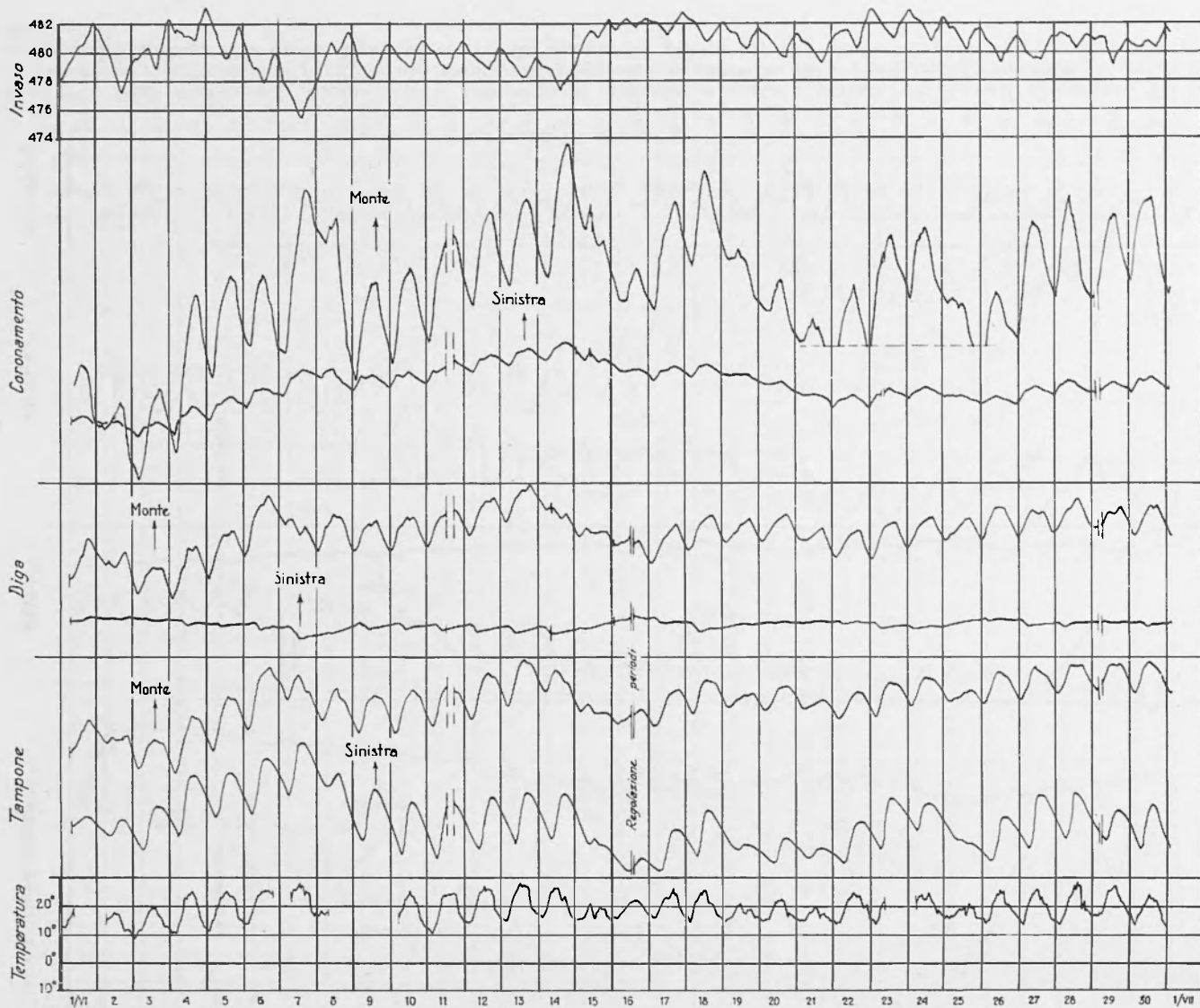
Fig. 19 - Diga Ambiesta - Giugno 1964 - Ferma restando l'entità delle ampiezze delle onde diurne, in direzione monte-valle, alla quota coronamento, le onde diurne delle componenti analoghe, a quota diga e tampone, vanno uguagliandosi in ampiezza. Ad es. nel giorno 12, si rileva, alla quota 436 (tampone), una variazione d'inclinazione di \sim 5'' e alla quota appena superiore (diga) si hanno 4'' - 5'' .
