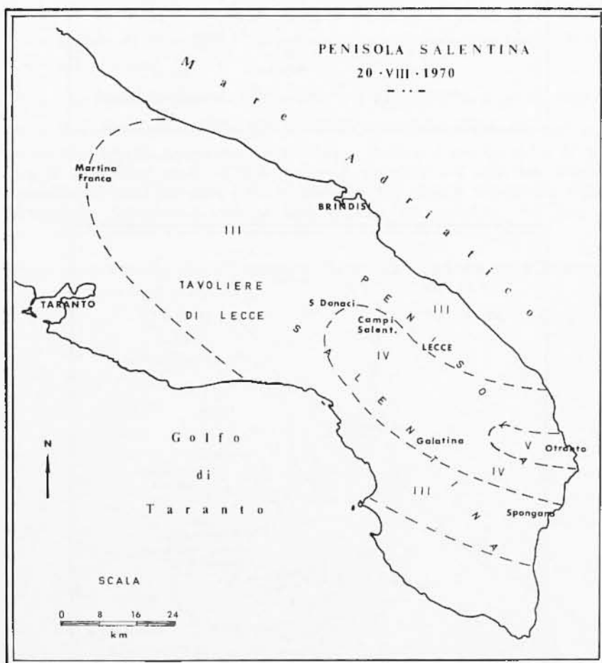
Fig. 8 - Le isosiste sono allungate nella direzione delle principali faglie (direzione appenninica). Le zone maggiormente interessate dall'evento sono sulle formazioni calcareo-arenacee mioceniche.
