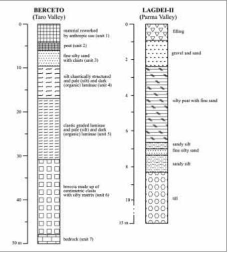
Figure 2 - Lithological features of Berceto and Lagdei-II boreholes. Litostratigrafia dei carotaggi di Berceto e di Lagdei-II.
