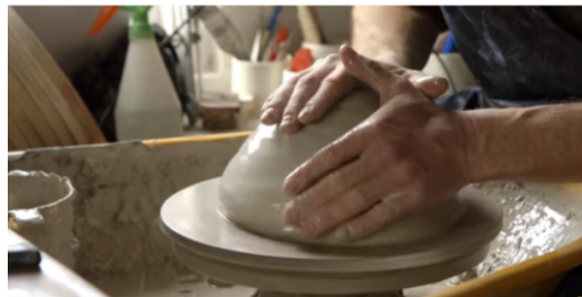
Görsel 19: Çömlekçi tornasında seramik form şekillendirme aşaması
