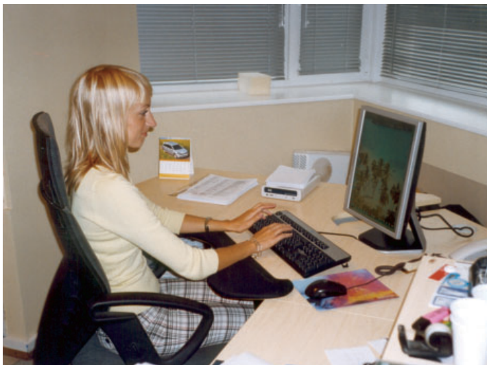
Foto 1. Kuvaterminal: reguleerimisvõimalustega töölaua ja -tool, spetsiaalne kühnartugi, reguleeritava kõrgusega LCD-kuvar.
