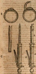
A Montre la grosse cannulle. B Autre cannulle qui entre dedans la grosse vis. C La pointe du pistolet qui sort d'ehors. D Le ressort qui fait debander le pistolet.
