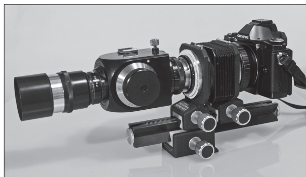
Figure 5. Camera with a macro lens on a carrier for recording selective focus Slika 5. Foto-aparat s makro objektivom na nosaču za snimanje selektivnog fokusa
