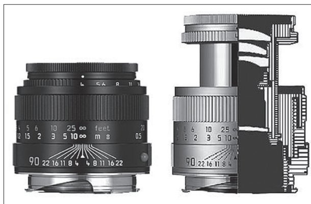
Figure 1. Cross section of modern macro lens Slika 1. Poprečni presek savremenog makro objektiva
